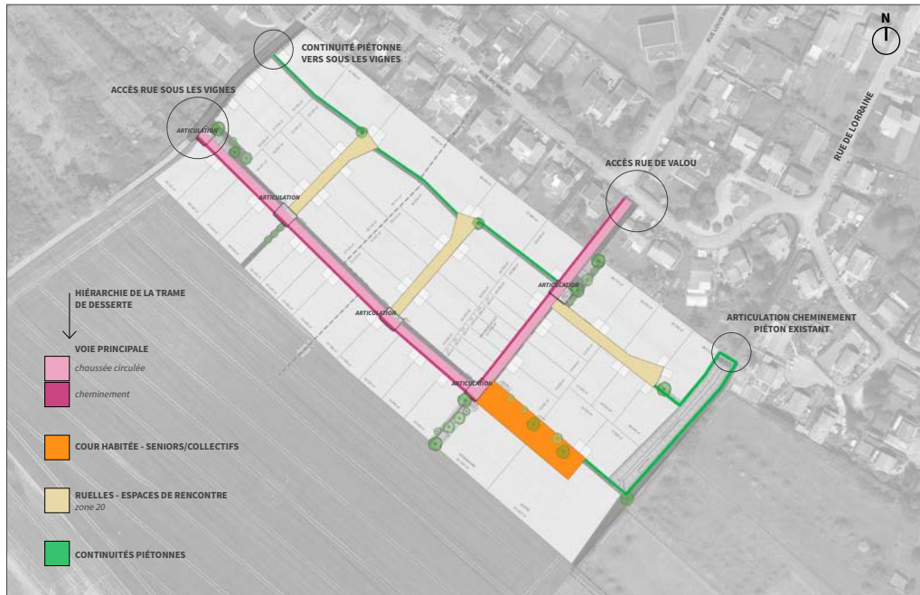
Circulations - cheminements - types de voies
